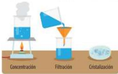
**Cristalización:** Aplica las propiedades de solubilidad, evaporación y la solidificación de las sustancias. Mediante esta técnica, podemos separar sólidos disueltos en líquidos, empleando cambios en la temperatura. Es utilizado en la producción de azúcar, sal y antibióticos.
